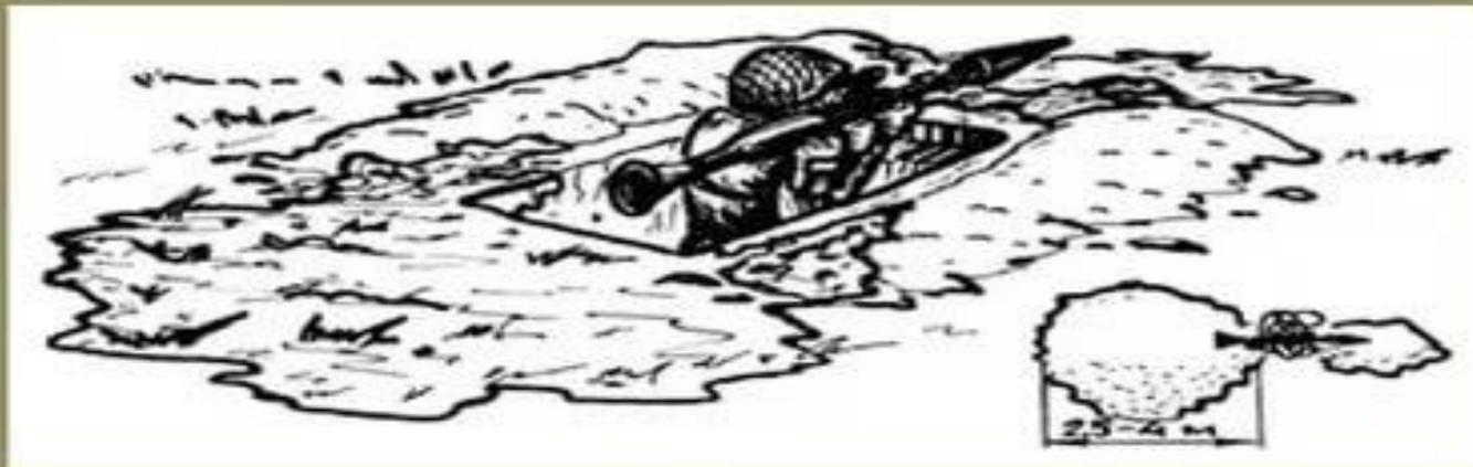
**Одиночный окоп** для стрельбы лежа состоит из выемки в грунте длиной 170 см, шириной 60 см, глубиной 30 см и бруствера высотой до 30 см. Для удобства стрельбы (опоры локтями) в передней части выемки оставляется ступенька шириной 25 – 30 см. При ведении огня из окопа в сторону одного из флангов высота бруствера со стороны противника (с фронта) делается на 20 см больше, чем в секторе обстрела.
